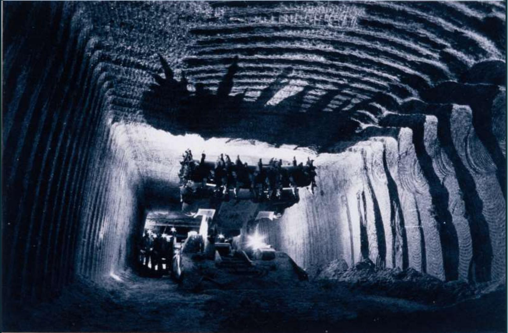
Fresa per scavare le caverne nel sale. Una volta che i contenitori vi sono stati immagazzinati, il sale lentamente si chiude stingendoli in una morsa che durerà almeno 50,000 anni.
