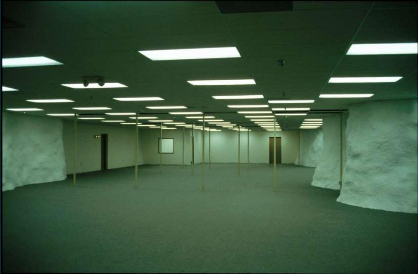
Locali da essere ancora utilizzati – Fatti pavimenti, controsoffitti, illuminazione, condizionamento, discese per impianti elettrici, impianti antincendio, intonaci con gunite dei pilastri di roccia rimasti in posto, divisori con pareti prefabbricate.
