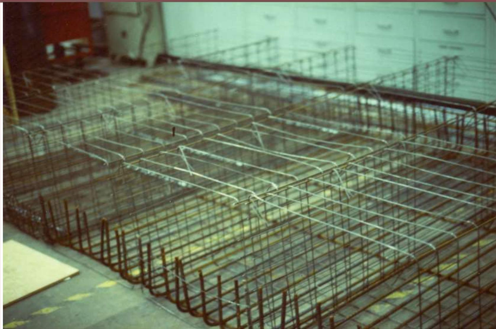
Costruzione di strutture da assoggettare poi a collaudi strutturali a distruzione
