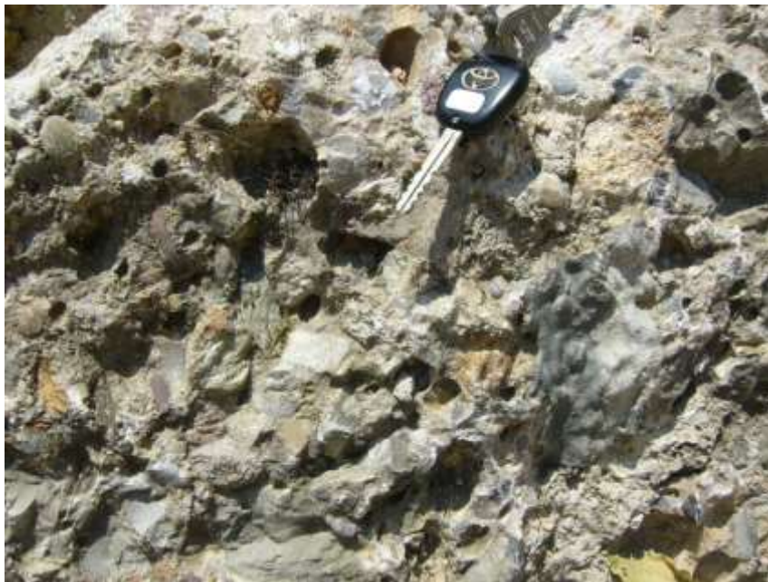
dettaglio del conglomerato detto “ceppo”: si nota la parte cementata e la presenza di alluvioni
