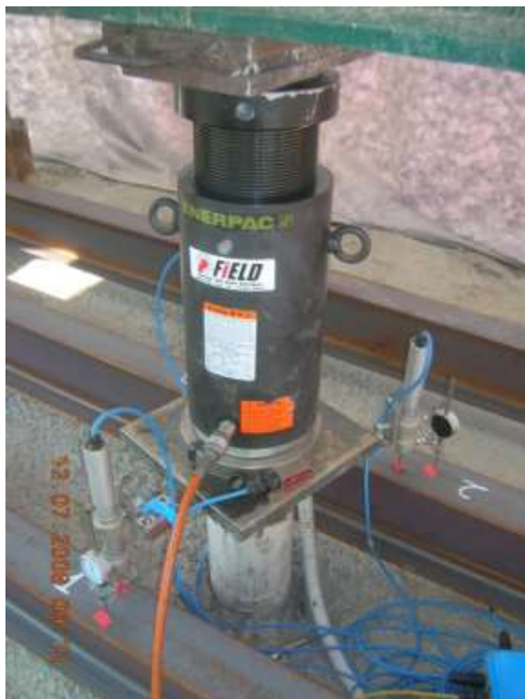
Prove di carico e misure su micro-palo strumentato
