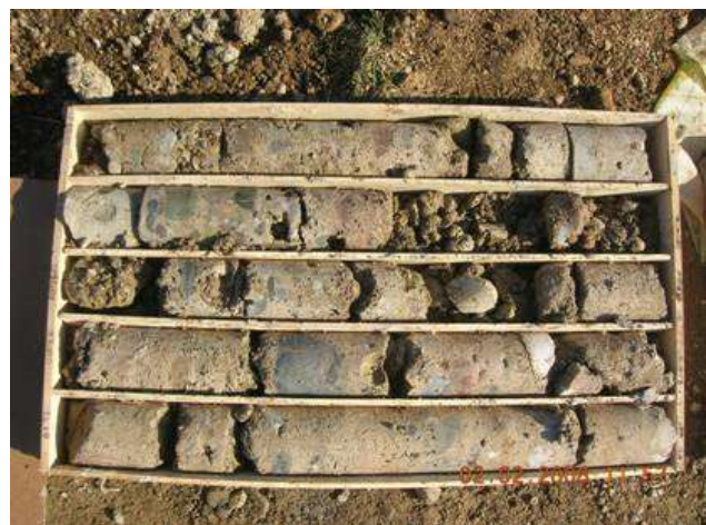
Indagini geognostiche aree fondazioni per verificare condizioni sottosuolo
