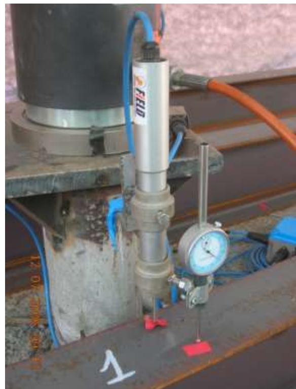
Prove di carico e misure su micro-palo strumentato
