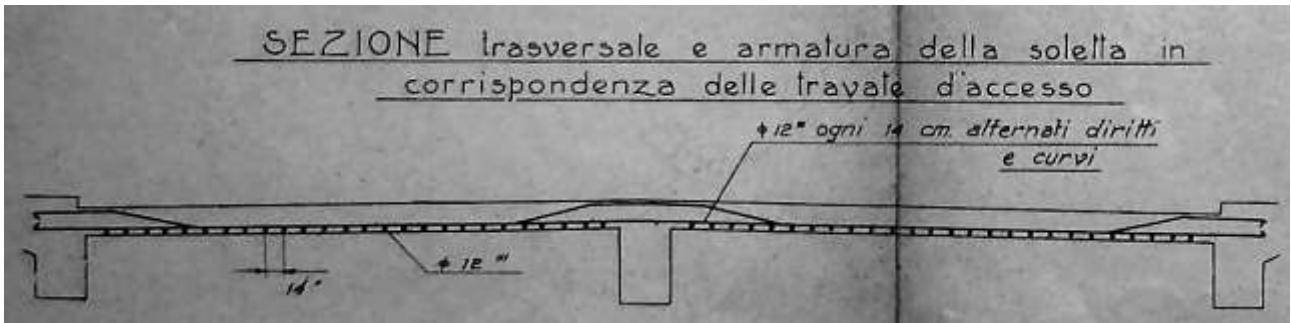
dettaglio armature metalliche della soletta sopra le travate di accesso
