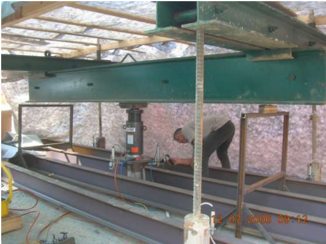
Prove di carico e misure su micro-palo strumentato
